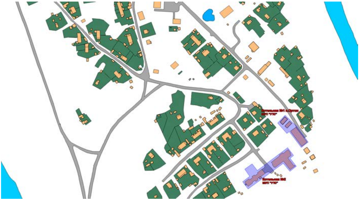
Рис. 2.6. Существующие зоны действия тепловых источников в п. Ортово по состоянию на 2017 г.
